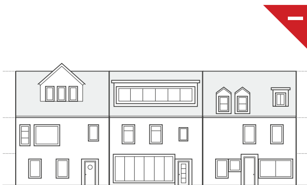
Abbildung 45: Trotz einheitlicher Höhen / Proportionen entsteht bei unangepassten Fassaden Unruhe.
